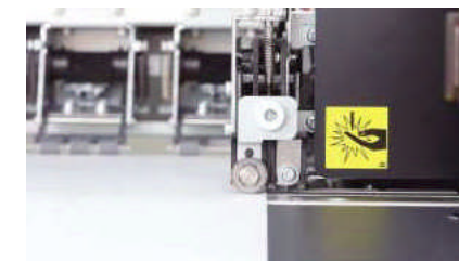
Kopfabstand stufenlos einstellbar auf 4 Positionen von 1,5 - 7 mm
