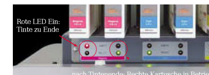
Rote LED Ein: Tinte zu Ende / nach Tintenende: Rechte Kartusche in Betrieb
